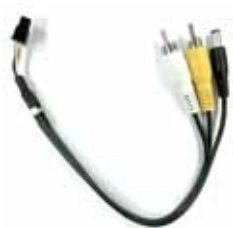
映像/音声出力ケーブル 映像(コンポジット)と音声出力(RCAオス)と電源出力(DCプラグ φ2.1×5.5mm) ※電源出力はカメラ電源出力と合計で1A
